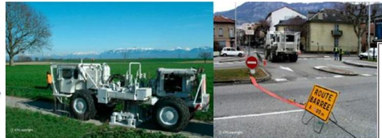
Figure 33 : Camion vibreur pour l'acquisition sismique, en milieu rural et en milieu urbain
